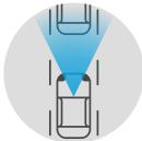
ИНТЕЛИГЕНТНО ПРЕДУПРЕДУВАЊЕ ВО СЛУЧАЈ НА МОЖЕН СУДАР Овој систем следи до две возила пред вас. Доколку системот открие ненадејно забавување напред ќе се вклучи звучно и визуелно со предупредување за да ја намалите брзината.
