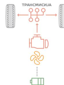
МОТОР ГЕНЕРАТОР БАТЕРИЈА
