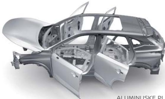
ALUMINIJSKE PLOČE VRATA I POKLOPCA MOTORA
